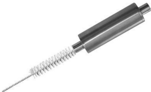
Rys. 8.1.1.8: Czyszczenie wkładu konwersji wagi
