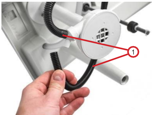
Rys. 6.3.4.4: Demontaż węży pompy
