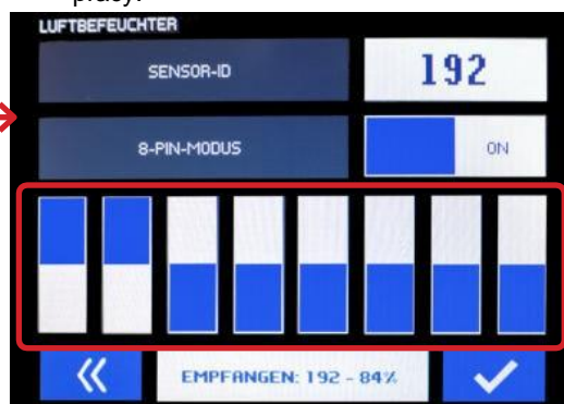
Rys. 5.6.7: Kodowanie radiowego nadajnika wilgotności
