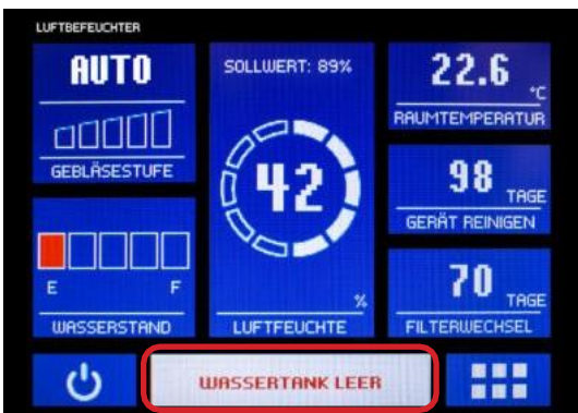
Rys. 7.2.1: Wskazanie usterki na wyświetlaczu dotykowym
