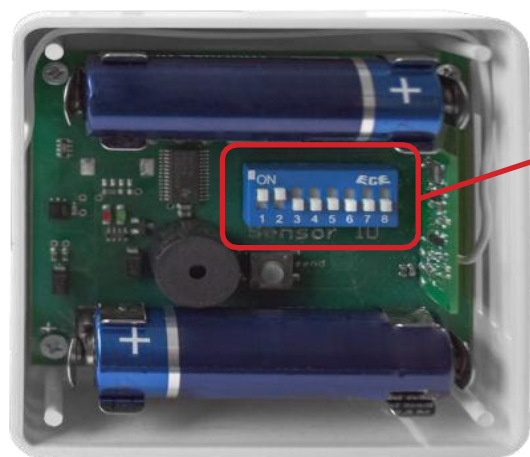
Rys. 5.6.1: Widok wnętrza radiowego nadajnika wilgotności
