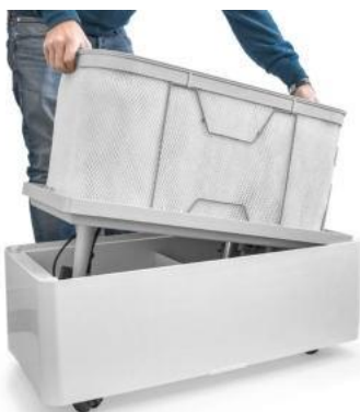
Rys. 6.3.1.4: Podnoszenie sekcji środkowej
