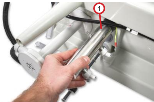
Rys. 8.1.2.5: Zdejmowanie obudowy sterylizatora UV
