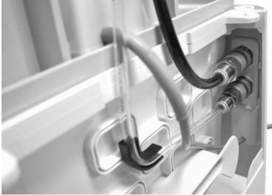
Rys. 6.3.4.12: Podłączenie kabla zasilającego, AWZ i urządzenia płuczącego
