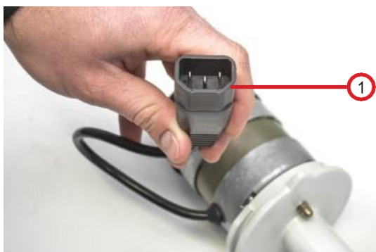
Rys. 7.4.1.7: Rozłączanie połączenia wtykowego
