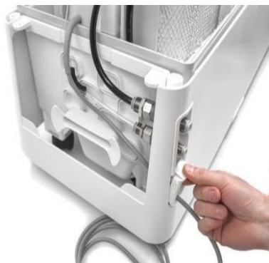
Rys. 7.4.2.1: Zdejmowanie górnej części obudowy
