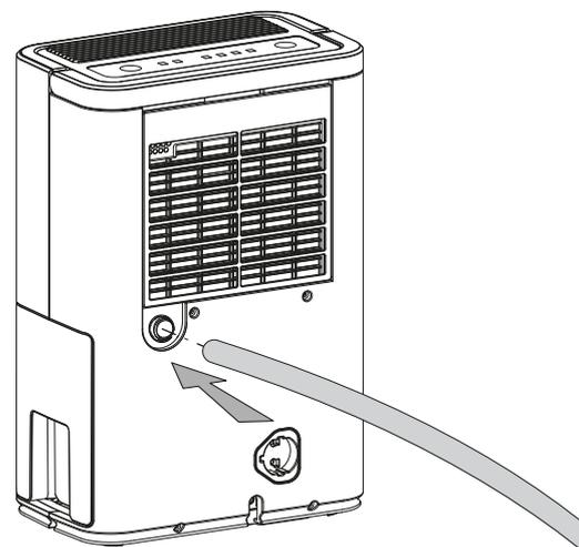
3. Conecte el otro extremo de la manguera a un desagüe apropiado (por ejemplo un sumidero o un recipiente colector suficientemente grande). Asegúrese de que la manguera no se pueda doblar.
