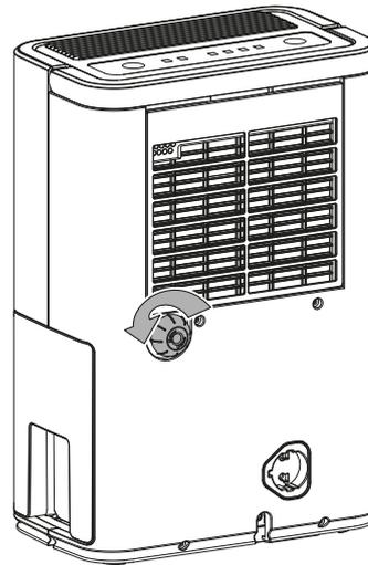
2. Conecte uno de los extremos de la manguera en la conexión de manguera.
