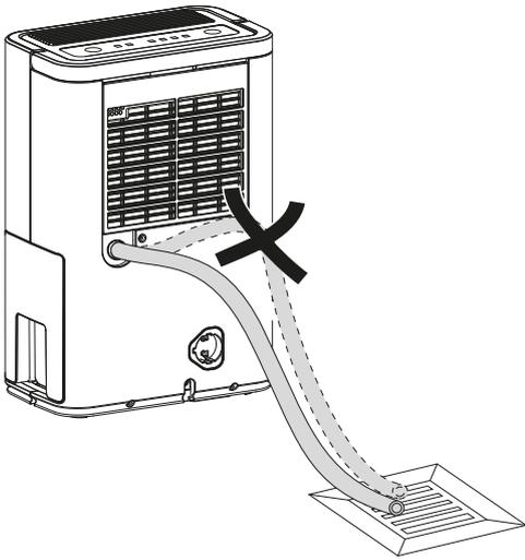
4. Cuando desee volver a recoger el agua condensada en el depósito, quite la manguera. Deje secar la manguera antes de guardarla.
