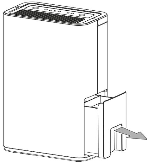
2. Vacíe el depósito de agua condensada en un desagüe o un fregadero.
