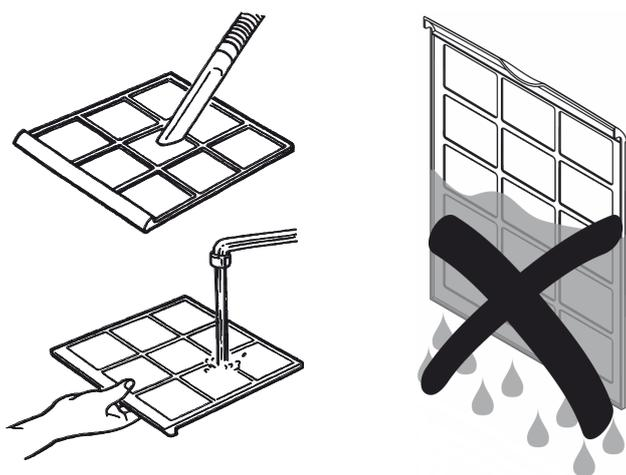
3. Laissez le filtre sécher complètement. N'insérez pas de filtre mouillé dans l'appareil !
