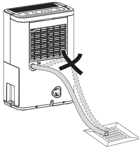
4. Retirez le flexible si vous voulez de nouveau faire s'écouler les condensats dans le réservoir de récupération des condensats. Faites sécher le flexible avant de le ranger.
