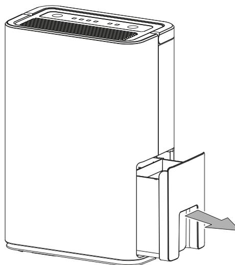
2. Videz le bac de récupération des condensats dans une conduite d'écoulement ou un évier.
