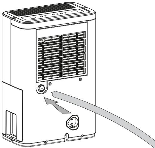
3. Posez l'autre extrémité du flexible dans une évacuation adéquate (par ex. une canalisation ou un bac collecteur suffisamment grand). Veillez à ne pas plier le flexible.
